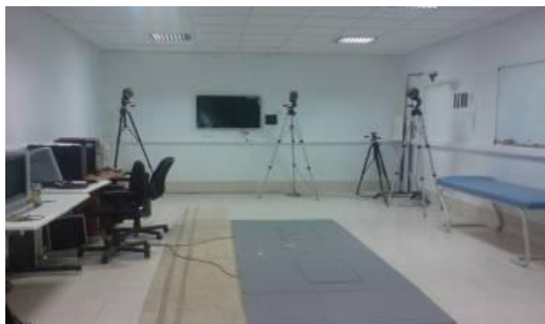
تصویر ۲. نحوه قرارگیری دوربین‌ها و صفحه نیرو در آزمایشگاه بیومکانیک
