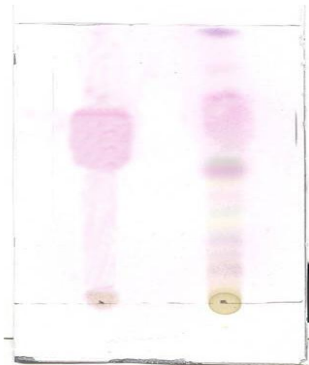
شکل شماره 1- کروماتوگرام حاصل از عصاره الکلی آویشن (سمت راست) در کنار کارواکروم تجاری (سمت چپ) 94 درصد
