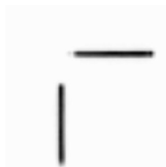
شکل شماره ۱- تصویر دو چشمه خطی (لوله مویینه) هر یک حاوی حدود 150 \mu Ci از پرتو داروی Tc^{99m} که در دو راستای کاملاً عمود بر یکدیگر و موازی با محور های افقی و عمودی در مرکز کلیماتور قرار داده شدند
